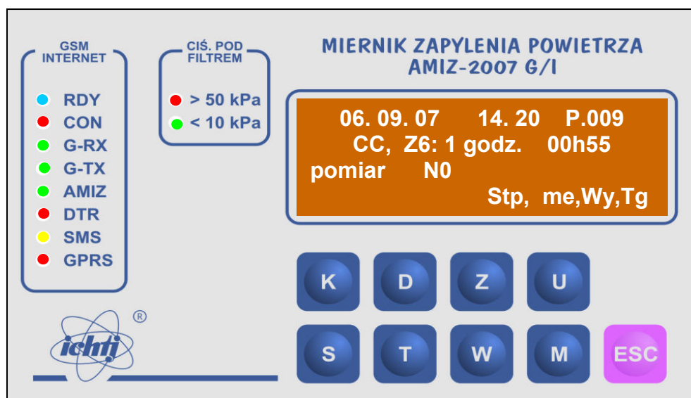
Rys. 4. Klawiatura, wyświetlacz i lampki kontrolne miernika.
